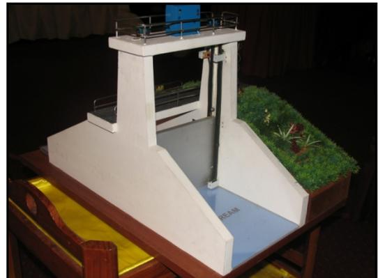
Model L-Scrap untuk pembersihan Teritip di permukaan pintu air dari JPS Batu Pahat
